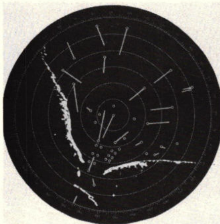
Afb. 3. Op het scherm van de Digiplot worden de 40 meest gevaarlijke targets volledig automatisch geplott. We zien hier het scherm bij het naderen van de haven van New York. (oriëntatie: north up).
