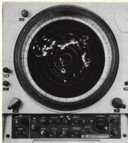
Afb. 2. Het bedieningspaneel en scherm van een Raytheon Mariners Pathfinder. Duidelijk zijn hierop de zes afstandsringen te zien.
